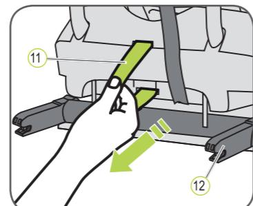
1. Потяните за серую матерчатую петлю 11, чтобы выдвинуть оба запорных устройства 12 в направляющие для фиксации 02, пока они не зафиксируются с обеих сторон со щелчком. С обеих сторон должны быть видны зеленые индикаторы ISOFIX 14.
