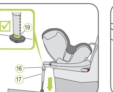
6. Нажмите обе кнопки регулировки 18 и выдвигайте опору 17 до тех пор, пока она не зафиксируется на полу автомобиля.
