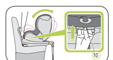
Сиденье DUALFIX может фиксироваться в нескольких положениях. Вы можете изменять положение наклона спинки, когда ребенок находится в сиденье. Вкладыш для младенцев обеспечивает поддержку позвоночника вашего малыша в ходе поездки. Установка вкладыша для младенцев:
