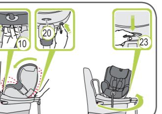
На сиденье DUALFIX есть серая предохранительная кнопка 20, которую следует нажать при переходе из группы 0+ в группу 1. Серая предохранительная кнопка 20 предотвращает риск ошибочного использования детского сиденья для ребенка, не входящего в указанную группу.
