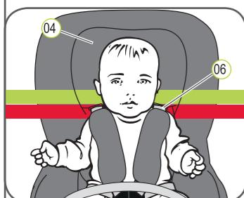
Правильно отрегулированный подголовник 04 обеспечивает оптимальную защиту ребенка на сиденье:
